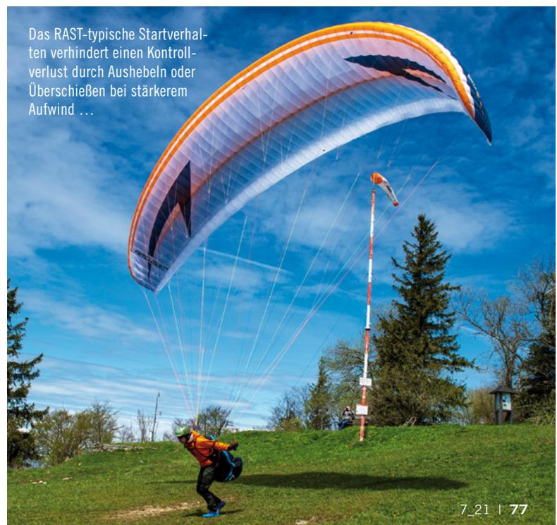
Das RAST-typische Startverhalten verhindert einen Kontrollverlust durch Aushebeln oder Überschießen bei stärkerem Aufwind ...
