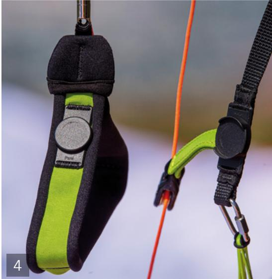
1. Überschaubarer Tragegurt mit B/C-Bridge für die Kontrolle beim Beschleunigen
